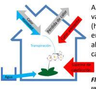
Al mismo tiempo, el vapor de agua del aire (humedad) se condensa en el proceso de absorción liberando calor útil.
