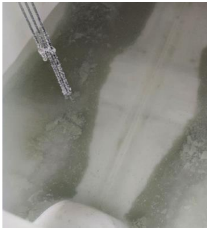
Rys. 1. Pompa membranowa z tworzącymi się kryształami (po lewej). Tworzenie się kryształów w zbiorniku stężonego roztworu (po prawej).
