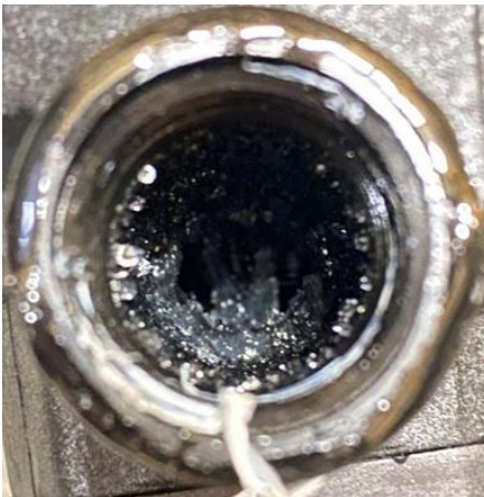
Rys. 1. Pompa membranowa z tworzącymi się kryształami (po lewej). Tworzenie się kryształów w zbiorniku stężonego roztworu (po prawej).
