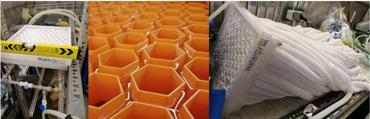
Figura 30. Il design dell'assorbitore con struttura interna esagonale stampata in 3D.
