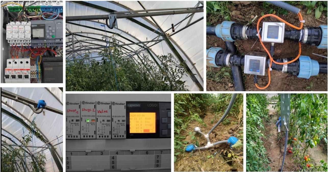
Figura 36. Installazione della scatola di controllo, dei sensori e del sistema di acquisizione dati.
