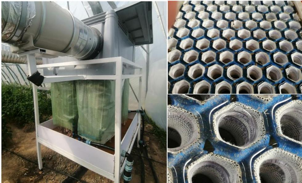
Figura 28. L'assorbitore installato nel dimostratore tunisino (a sinistra) e la struttura interna dell'assorbitore (a destra).
