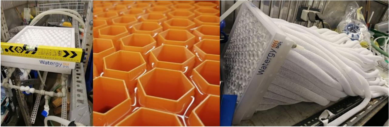
Figure 30. La conception de l'absorbeur avec une structure interne hexagonale imprimée en 3D.
