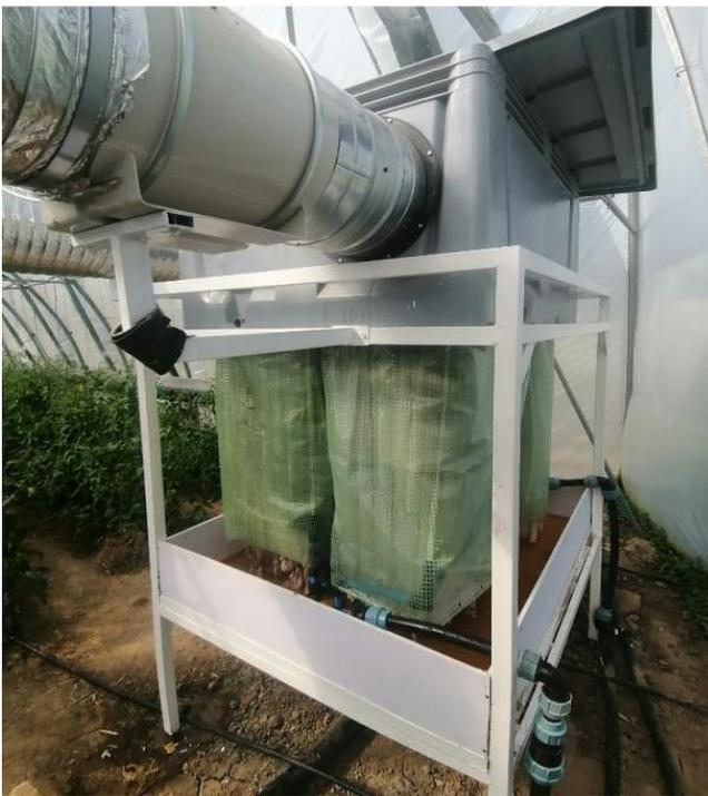
Die hygroskopische Eigenschaft des Trockenmittels ermöglicht eine höhere Taupunkttemperatur in der Tagesphase im Vergleich zu einem System, das Wasser als Speichermaterial verwendet. Auf diese Weise wird weniger Kühlung (passiv durch Nachttemperatur erzeugt) für den Prozess benötigt und die Kühlung wird durch Wärme ersetzt, da mehr Wärme während der Regenerationsphase erforderlich ist, um die anfängliche Trockenmittelkonzentration für der nächsten Tage wiederzuerlangen.
