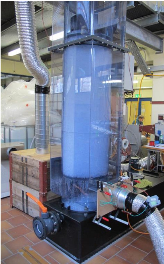
Figura 9. Absorbedor transparente en ZHAW-lab (izquierda) y el absorbedor instalado en el demostrador suizo (derecha).
