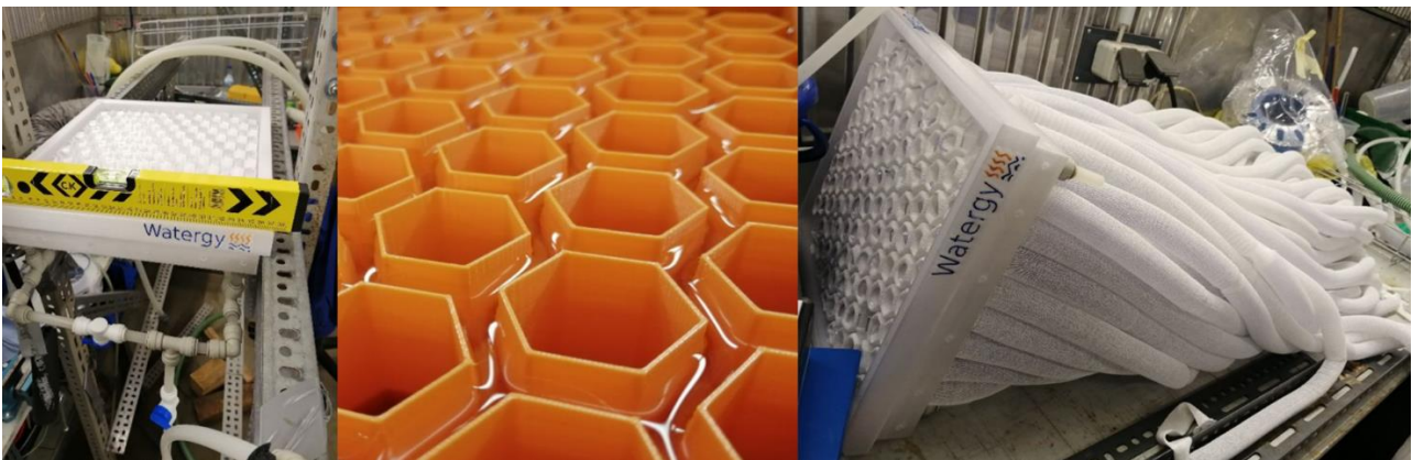
Figura 30. El diseño del absorbente con estructura interna hexagonal impresa en 3D.
