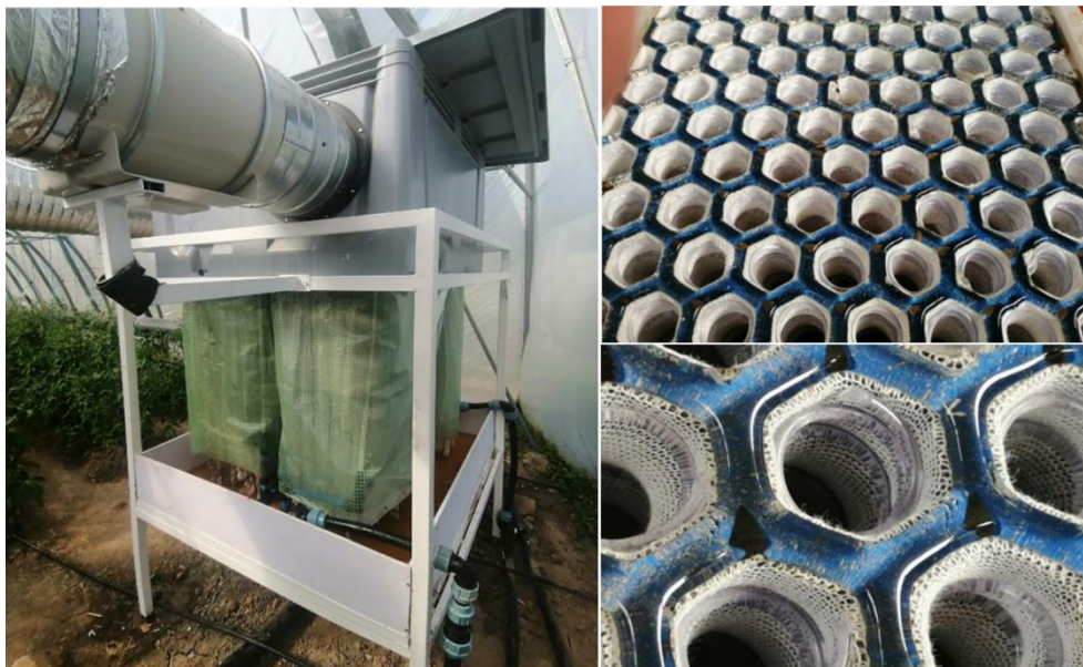
Rys. 28. Absorber zainstalowany w tunezyjskim urządzeniu demonstracyjnym (po lewej) i wewnętrzna struktura absorbera (po prawej).
